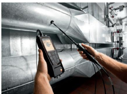
Doar atunci când sistemele de admisie și refulare a aerului sunt reglate corespunzător instalațiile pot funcționa la capacitate maximă. La Testo, nu veți găsi doar instrumente și sonde pentru măsurarea în tubulaturi de ventilație, dar și balometre și pâlnii pentru măsurarea cu precizie a debitelor de aer la grilele de ventilație. Instrumentul multifuncțional testo 480 vă ghidează la măsurarea în rețea a sistemelor VAC, conform standardelor din domeniu.
