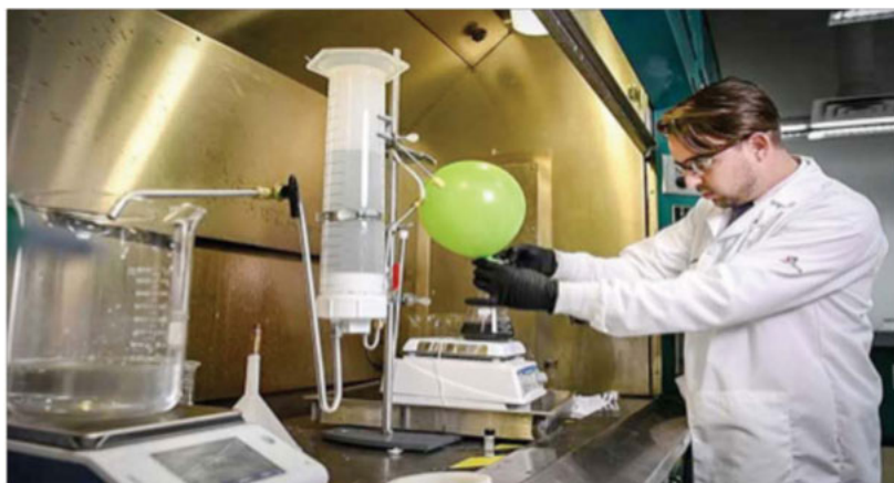
Fig. 2. Utilizarea nanopudrei de aluminiu la generarea hidrogenului (Anthony J. Roberts de la ARL unflă un balon cu hidrogen produs dintr-o reacție chimică dintre apă și o pulbere de nanomateriale de aluminiu.)
