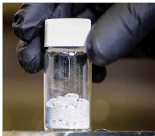
Fig. 1. Nanopulbere stabilă din aliaj de aluminiu. Pulberea nanogalvanică de aluminiu este stabilă din punct de vedere structural.
