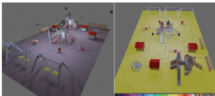
Figura 3 Soluția 1 - Nivel iluminare mediu propus E_m=50 lx
