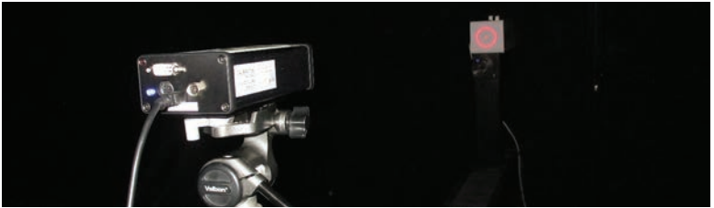
Fig. 2 – Măsurarea radiației spectrale într-un FOV de 11 mrad, centrat pe suprafața emisivă a sursei de lumină
