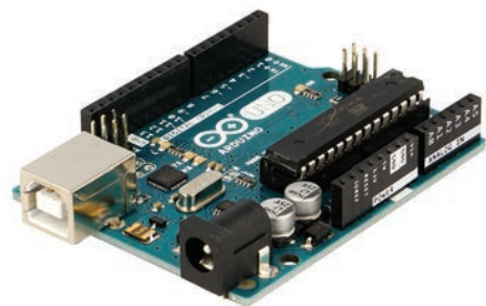
Arduino UNO poate fi alimentat prin intermediul unui conector USB sau al unui jack de 5,5 mm
