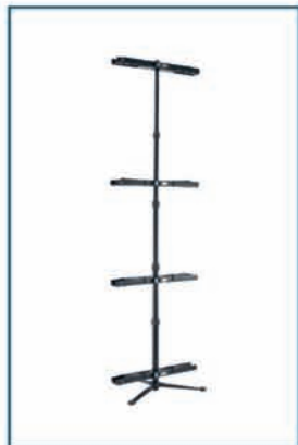
Trepied pentru măsurări de confort
