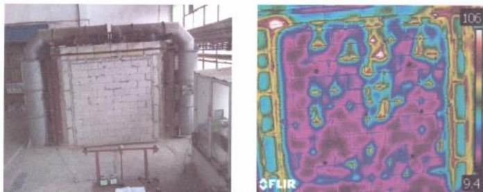
Foto 9 – Distribuția temperaturii pe fața neexpusă la foc a epruvetei în minutul 180 al încercării de rezistență la focul standard
