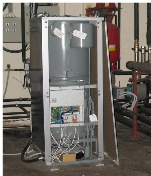
Fig. 4.6. Vedere generala instalatie frigorifica cu absorbtie experimentală amplasata in laborator.
