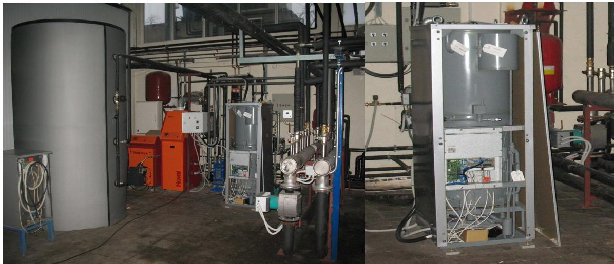
Fig. 4.4. Instalatie frigorifica cu absorbtie BrLi – apă alimentata cu energie solară – model experimental.
