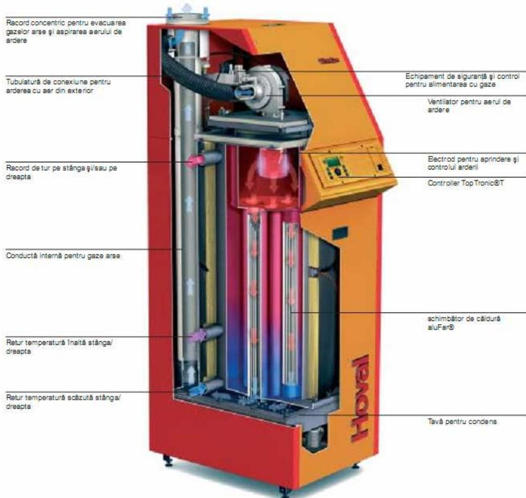
Fig. 4.5. Vedere de ansamblu cazan in condensatie tip ULTRA GAS.
